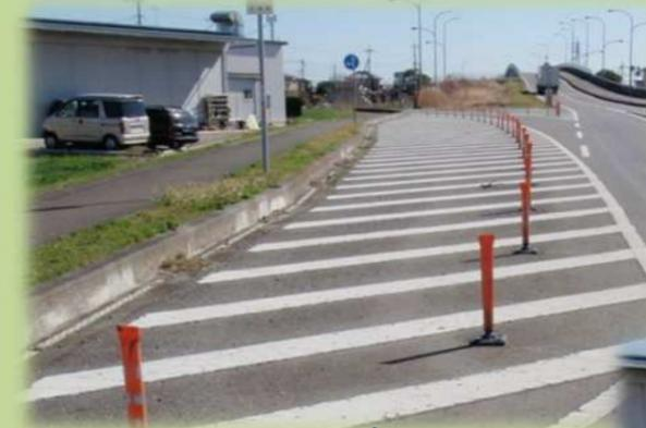
既設の車線分離標に本体をかぶせ、固定シートで貼りつけるものです。φ80のサイズであれば取付可能で圧倒的な視認性を発揮します。表面はセルフクリーニングシート仕上げで、交換時期を延ばせて、経済的です。
